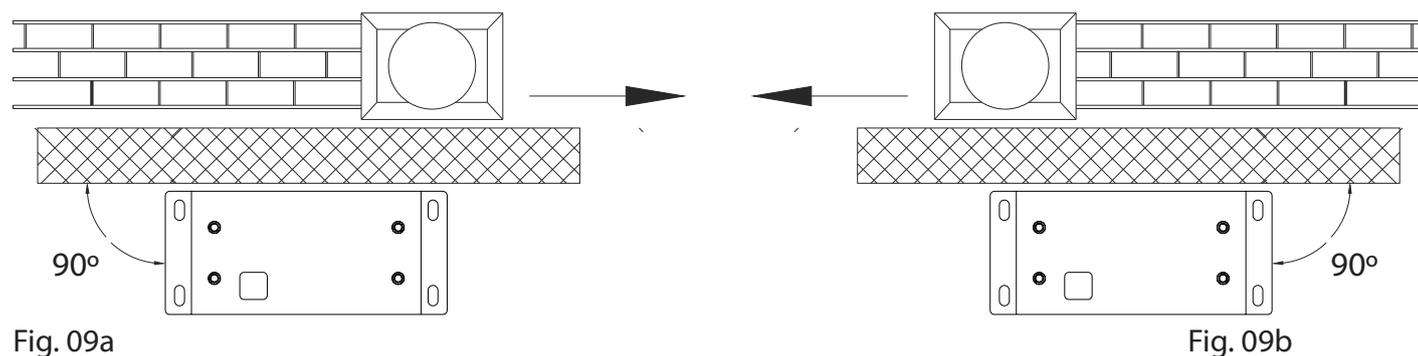
b) Atornille la chapa/placa de fijación al suelo, utilizando los tornillos previamente fijados al suelo dejando uno o más tubos para pasar los cables eléctricos a través de la chapa/placa (Fig.10 y Fig. 11). Utilizando un nivel, compruebe si la chapa/placa está perfectamente horizontal.
