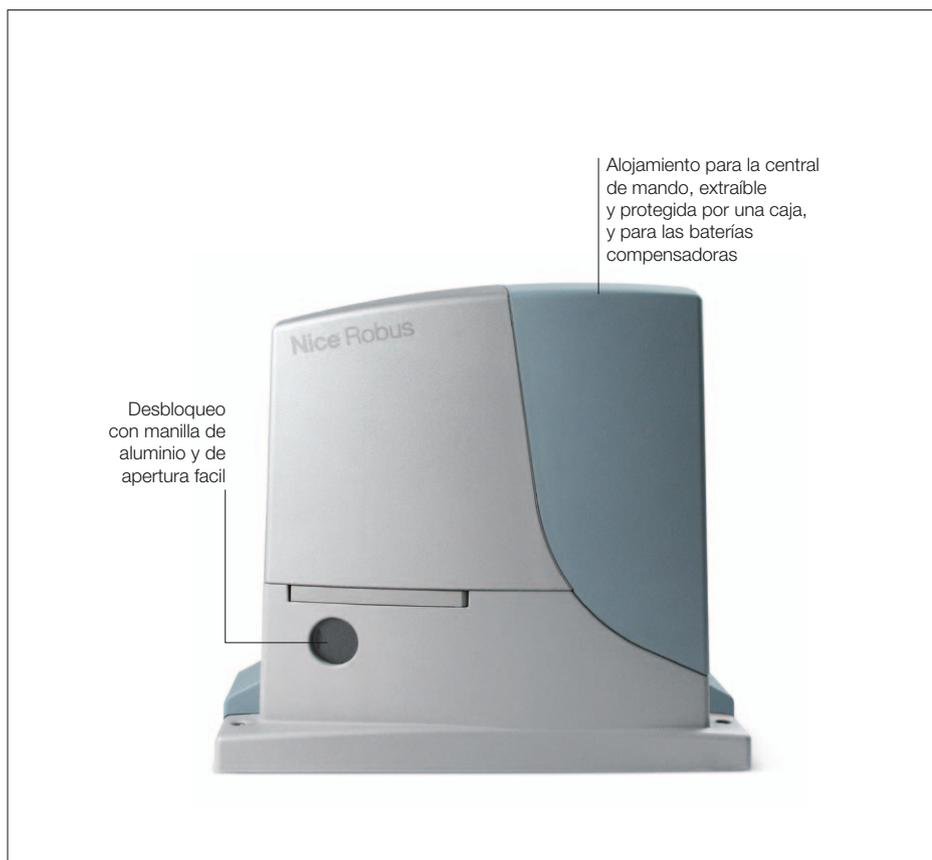
**Para puertas correderas de hasta 400 kg (RB400) y 1000 kg (RB1000). Motorreductor electromecánico con tecnología Nice BlueBUS. Versiones con fines de carrera eletromecánicos (RB600/RB1000) y con fines de carrera inductivo (RB600P/RB1000P).**
