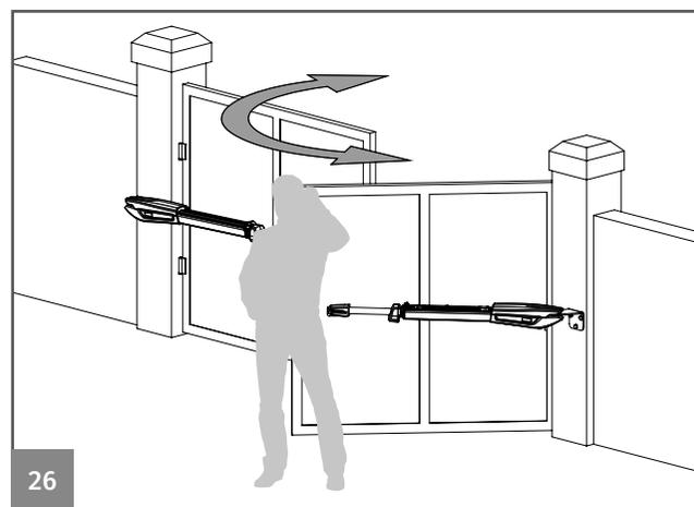
09 • Pruebe la puerta manualmente y si fuere necesario vuelva a ajustar los micros, como se indica en los puntos anteriores.
