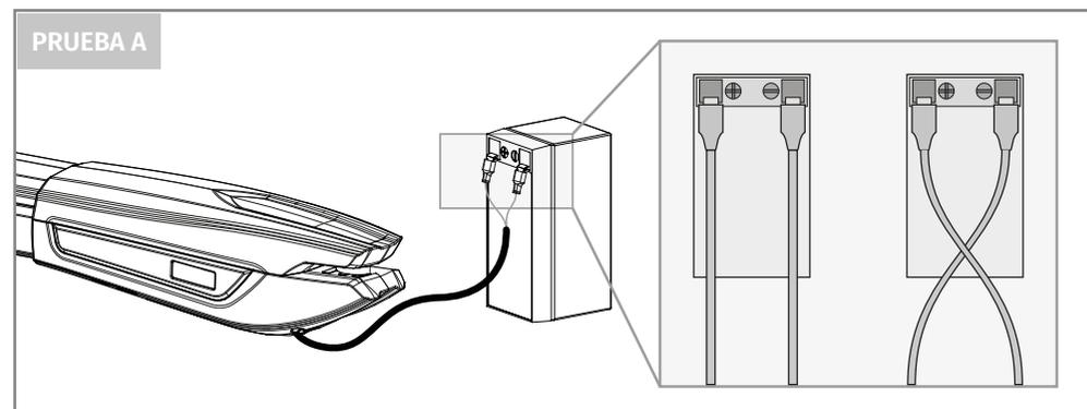
**Prueba A** • Haga las conexiones como se indica en la imagen. Si el motor funciona, el problema está en la central. Si no funciona tiene que hacer el punto B.
