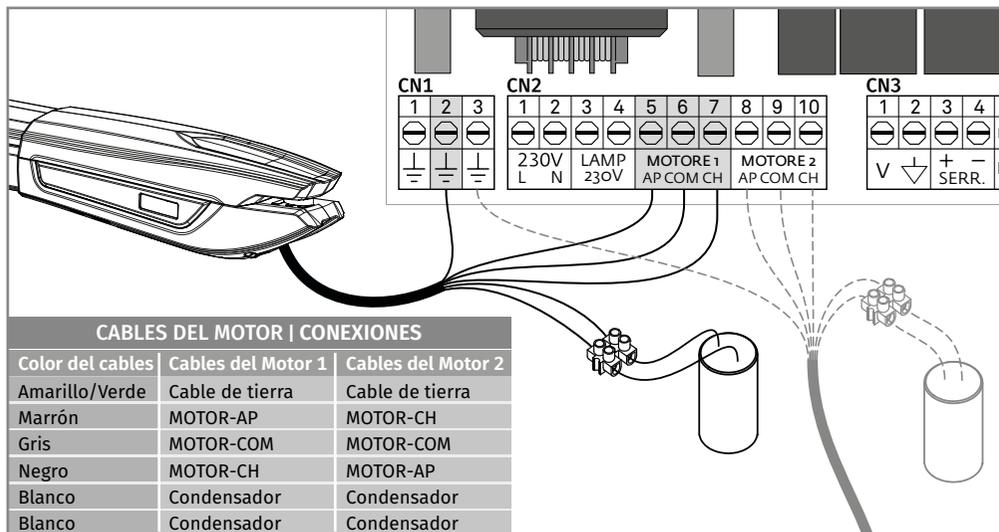
Deben hacer las conexiones como se muestra arriba, conectando los 6 cables del motor en las entradas correspondientes de la central y del condensador.
