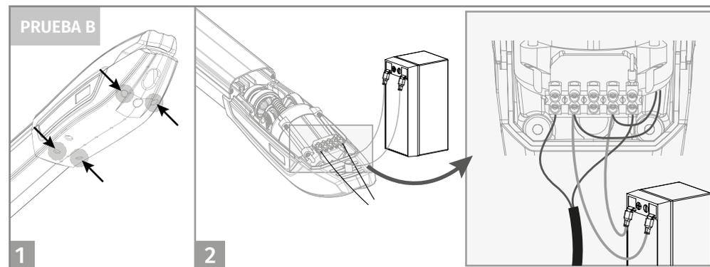
**Prueba B** • Afloje los 4 tornillos para retirar la tapa y acceder a las conexiones internas. Haga las conexiones como se indica en la imagen. Si el motor funciona, el problema estará en el diodo(s) o en el micro(s). Si no funciona, haga la sustitución por un motor de 24V nuevo y vuelva a probar para garantizar que está todo bien.
