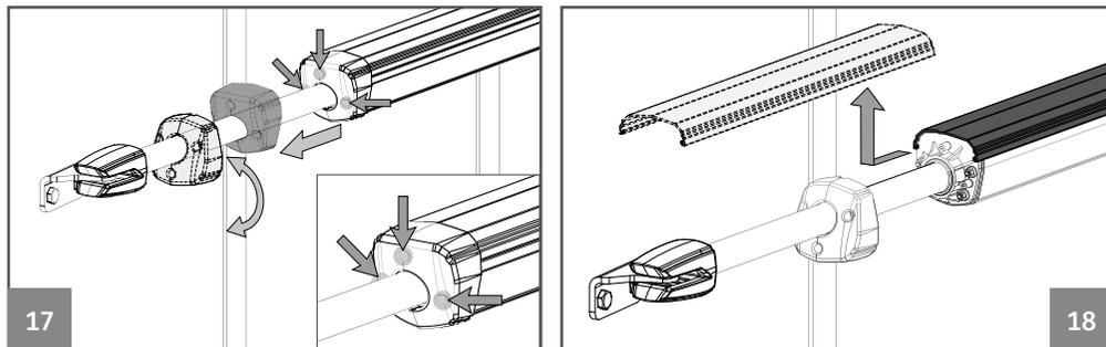
02 • Afloje los 3 tornillos delanteros, retire la tapa delantera y la tapa del perfil.
